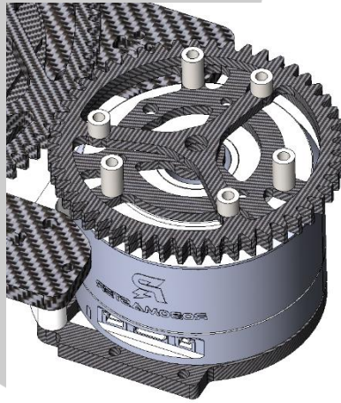
图 4-11 Yaw 轴消回差设计图
